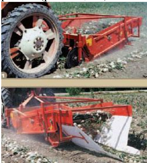
Рис. 61. Викопування цибулі і укладання у валки.
