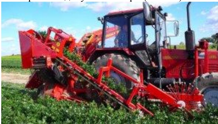
Рис. 71. Морквозбиральна машина серії PS брального типу.
