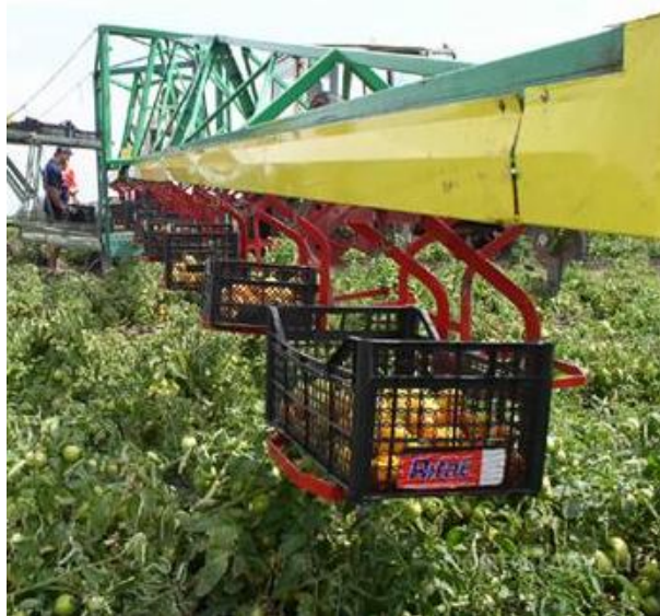
Рис. 50. Широкозахватний транспортер для збирання овочів ТОК-18.
